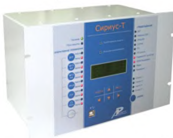
Рисунок 2 Внешний вид микропроцессорного устройства релейной защиты Сириус-Т
